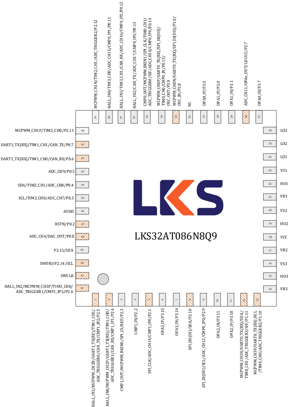
图 3-1 LKS32AT086N8Q9(B)管脚分布图
