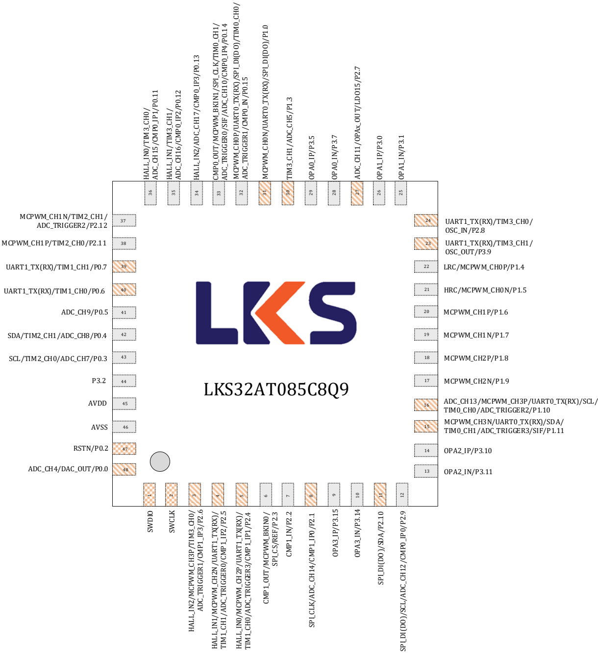
图 2-1 LKS32AT085C8Q9(B)管脚分布图
